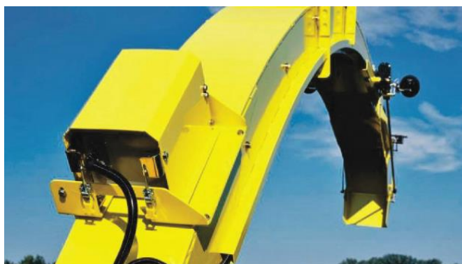
Figur 1: Finsnittere med udbyttmåler og NIR sensor kan ret præcist måle tørstofudbyttet, når udbyttmåleren er kalibreret forinden.
